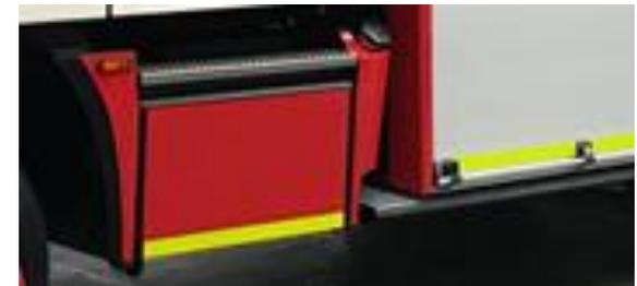
Breitere ausklappbare Stufen
